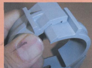
横スライドする事で地震時の動きウォーターハンマー発生時に対応します。
